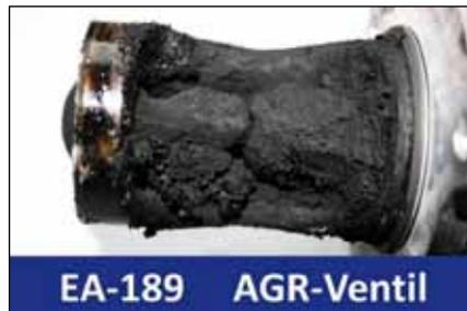
Von entscheidender zentraler Bedeutung scheint dabei in den Rechtfertigungen der Autohersteller das „Thermofenster“ zu sein. Das Thermofenster liegt laut deren Angaben in der Regel bei Außentemperaturen zwischen 10 und 20° C und weicht nur minimal zwischen den Herstellern ab. Danach muss innerhalb des Thermofensters die AGR-Rate reduziert werden, um Beschädigungen des Motors zu verhindern. Ansonsten drohe eine Versottung und Verlackung im AGR-System.
